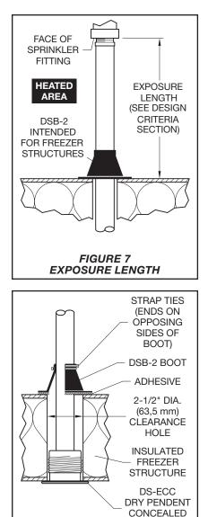
SPRINKLER FIGURE 8 MODEL DSB-2 DRY SPRINKLER BOOT WITH PENDENT SERIES DS-ECC DRY-TYPE SPRINKLER
